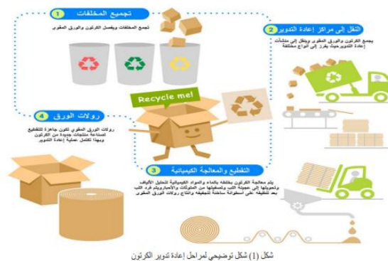
شكل (1) توضح مراحل إعادة تدوير الكرتون
